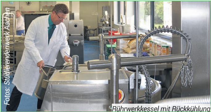
Rührwerkessel mit Rückkühlung
